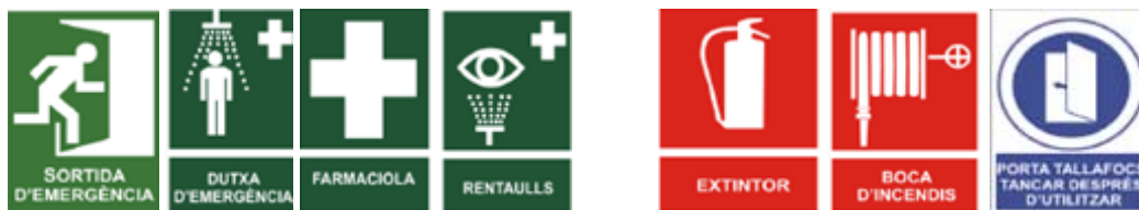
Fig 1 Senyalització de Seguretat: Sortida d'Emergència, Dutxa d'Emergència, Rentaüells, Farmaciola, Extintor, Boca d'Incendis i Porta Tallafocs.
